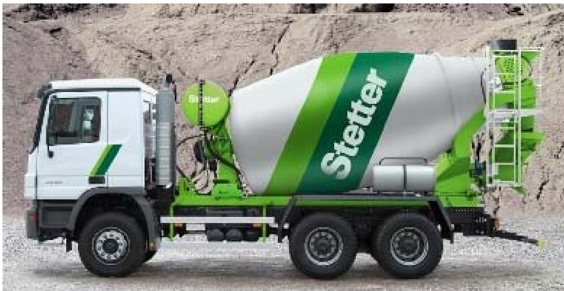
Ilustracija br.1. – Motorno vozilo s ugrađenom rotacionom mješalicom za beton, (tarifni broj 8705).
